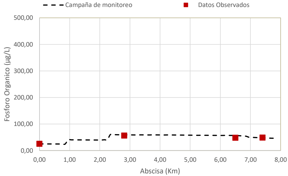
Figura 71. Calibración Fosforo Orgánico – Quebrada La Clara Fuente. Universidad de Antioquia, 2024.
