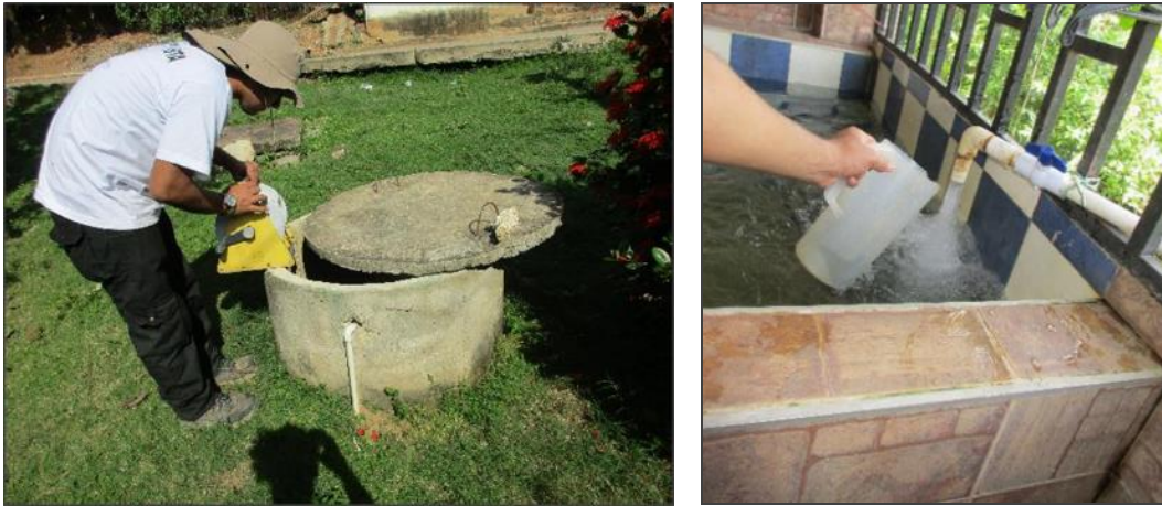
Fotografías. Medición de nivel estático en un aljibe (izquierda), aforo volumétrico en una captación (derecha).
