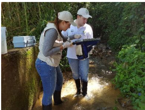
Fotografía. Monitoreo de Parámetros fisicoquímicos utilizando el multi paramétrico
