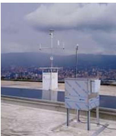
Fotografía. Equipo de medición Black Carbon - Itagüí
