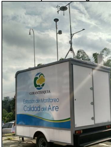
Foto. Estación fija de monitoreo de calidad del aire-PM 2,5. Municipio de Envigado Institución Universitaria de Envigado mayo de 2015.
