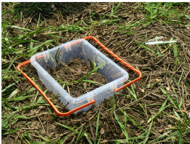
Foto. Trampa para la captura de dióxido de carbono y metano
