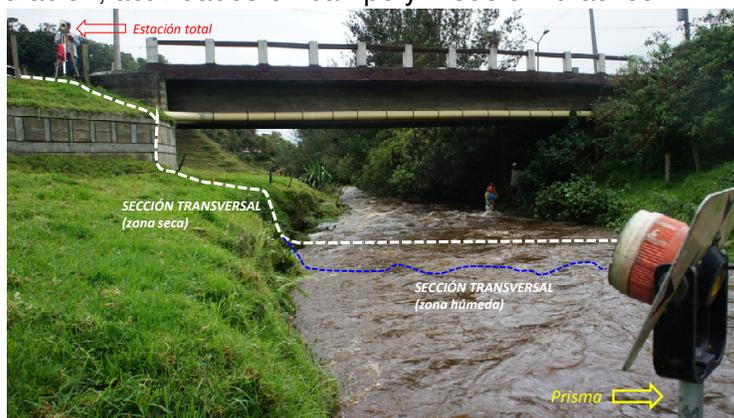
Esquematzación del procedimiento para el levantamiento de una sección transversal
