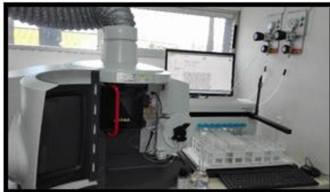
Espectrómetro de emisión de plasma acoplado inductivamente
